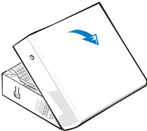
4. Si su sistema tiene un chasis de minigabinete vertical, desmonte la cubierta de la computadora de la manera siguiente:
